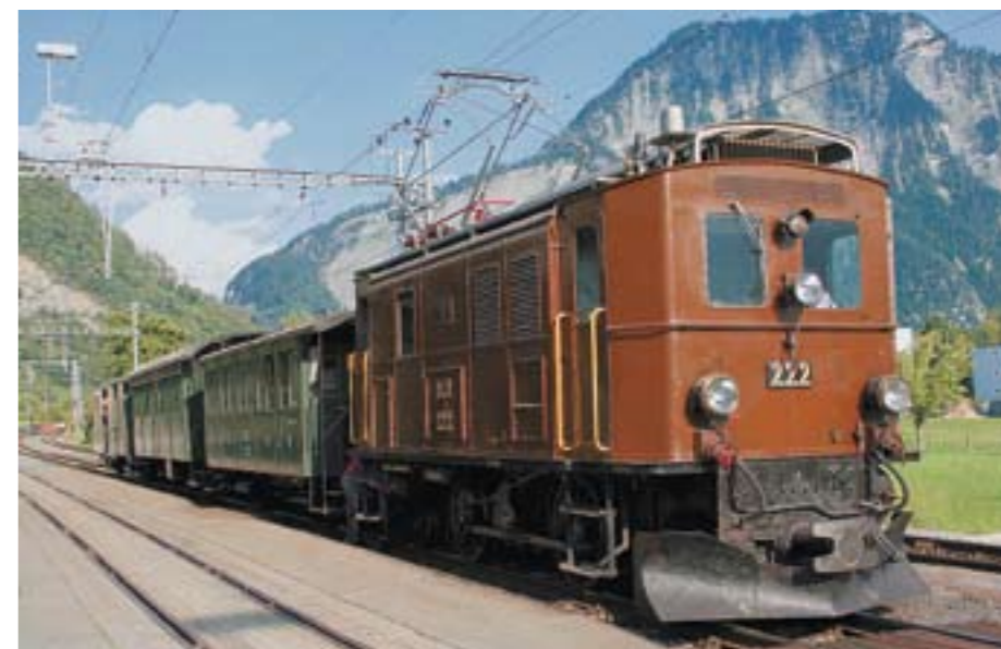
Von den Lokomotiven Ge 2/4 aus dem Jahre 1913 hatte die RhB einst sieben Exemplare. Die 222 darf im jetzigen Zustand nur noch mit maximal 30 km/h fahren. In Malans erholt sie sich vor ihrer Heimfahrt.
